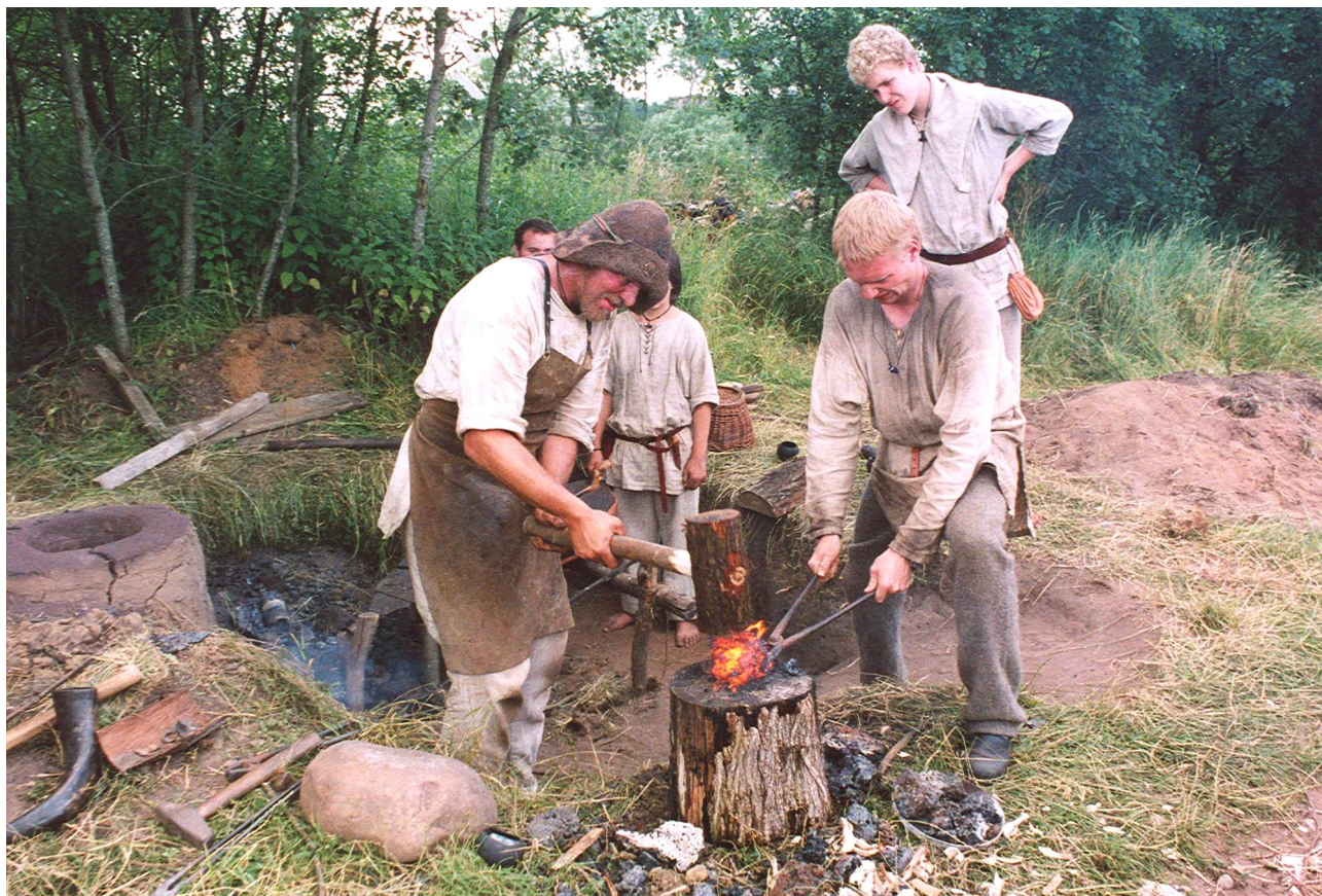
Ribe Vikingecenter, 17. juli 2004. En luppe på ca. 3,5 kg smedes på træstub med træhammer. Luppen blev udtaget af ovnen i vikingecenterets åbningstid, kun ca. 4 timer efter første malmpåfyldning, så publikum havde mulighed for at se smede-processen. Materialeforbruget var 40 kg trækul og 30 kg ristet myremalm.
