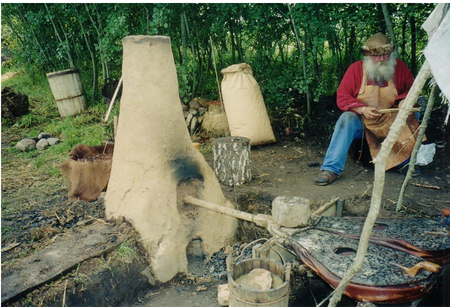
Jernudvindingsforsøg d. 8. august 2001. Ovnen ligner Espevej/Skovmark-ovnen på en række punkter. I løbet af 2\frac{1}{2} time påfyldtes ca. 20 kg malm. Resultatet blev en luppe på knap 1,3 kg.
